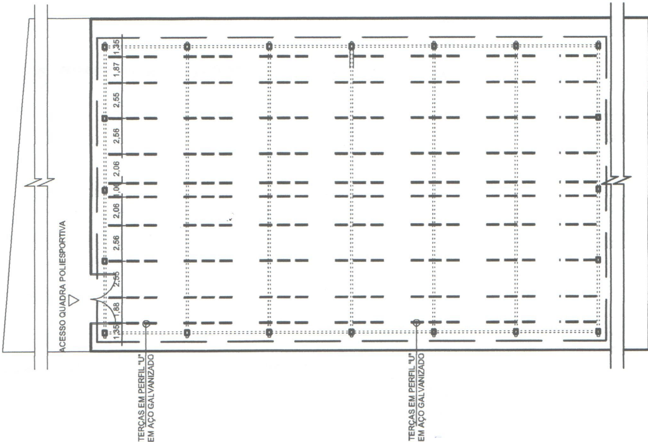
Planta Baixa de Cobertura - Terças Esc.: 1/250
